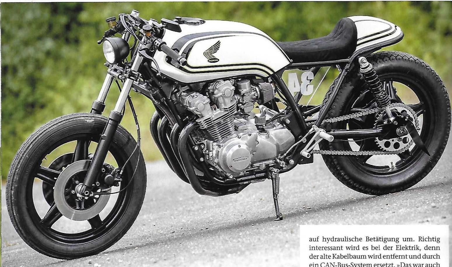
Auch Gabel und Bremsen belassen die Benders so, wie sie einst entworfen wurden. Lediglich das Innenleben der Forke wird mit progressiven Federelementen aufgewertet, am Heck speziell angefertigte Wilbers-Federbeine platziert. Die alten Bremsschläuche werden durch Stahlflexleitungen ersetzt, die altertümliche Bremspumpe durch eine moderne, radiale von Magura. Und da an den obligatorischen Lenkerstummeln sowieso neue Komponenten zum Einsatz kommen, bauen die Benders die Kupplung von Seilzug
