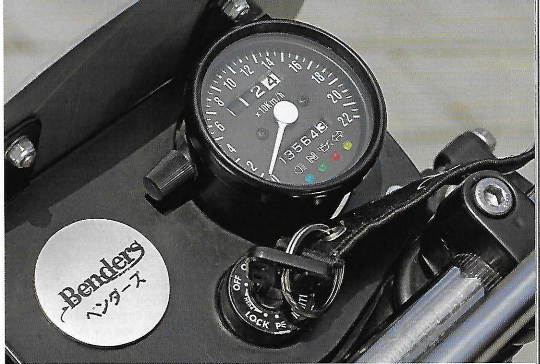
**Analoger Tacho mit vier Service-Leuchten und Öl-Thermometer im oberen Rahmenrohr, mehr braucht's nicht**
